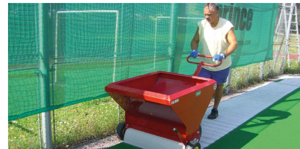
6_Relleno de arena
